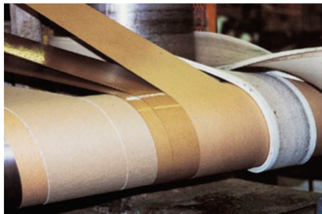
TUBEROLL 压带的技术规格 橡胶材料类型：NA65及NB67 1
